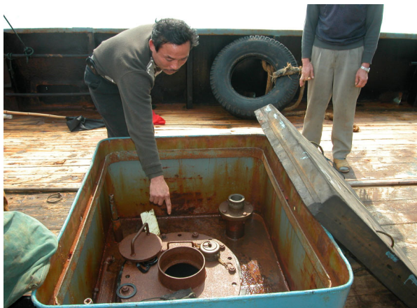
▲ 「閩肖漁 F079 號」漁船船艙改裝為儲油槽
