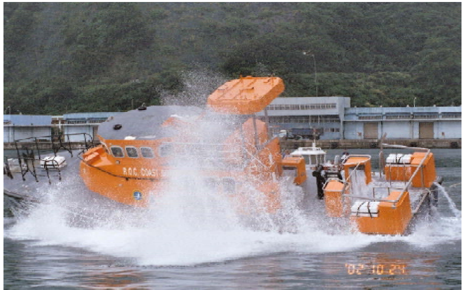
▲ RB 搜救艇自動扶正測試
