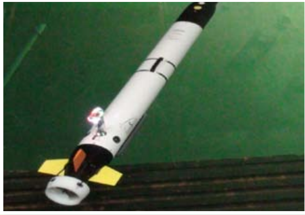
▲ 圖二、測試中的AUV Iver2 (影像來源:台灣海洋科技研究中心) PIC 2. AUV Iver 2 in test (Source: Taiwan Marine S & T Research Center)
