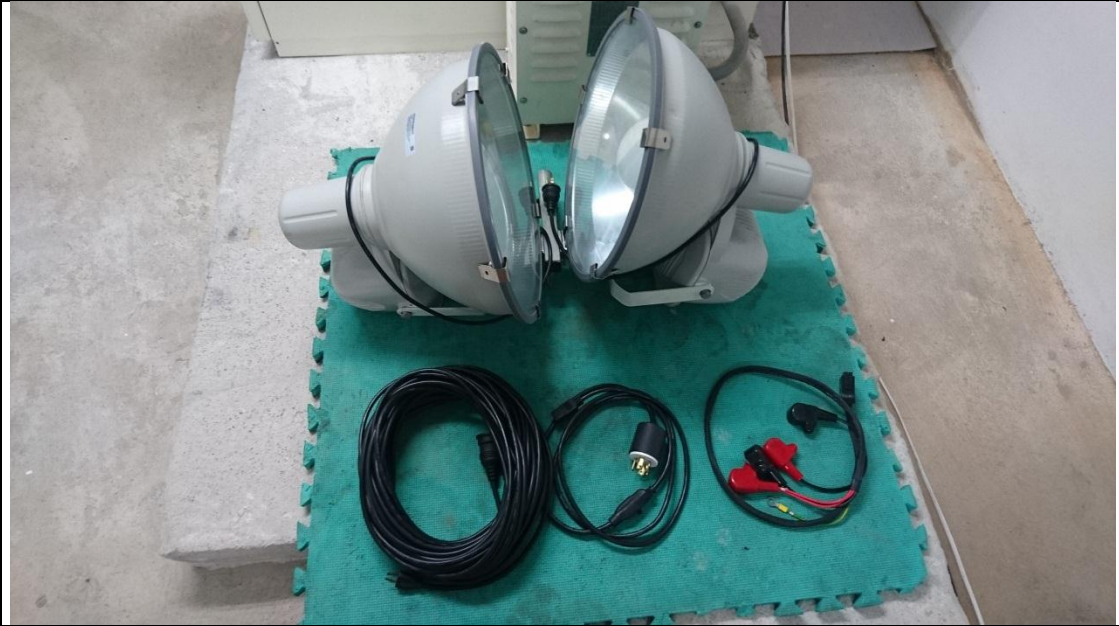
消防搶救照明燈
