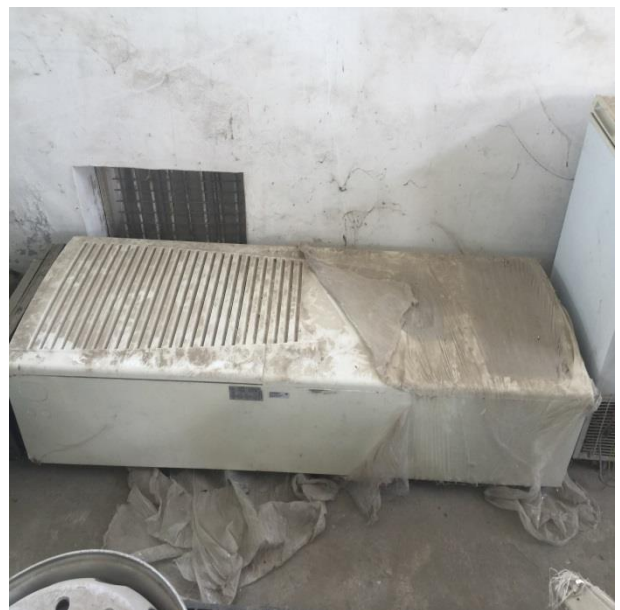
項次 15 氣冷式箱型冷氣機
