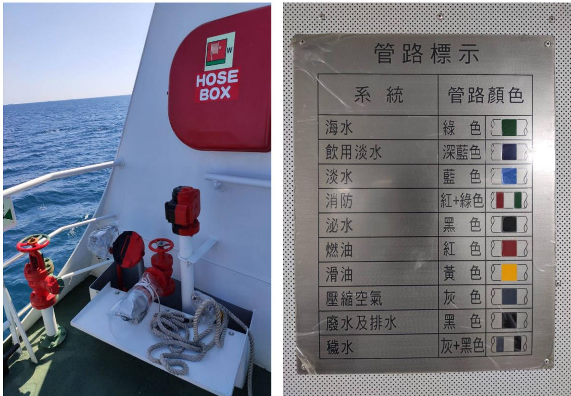
圖 8：艦船艇管路識別顏色
