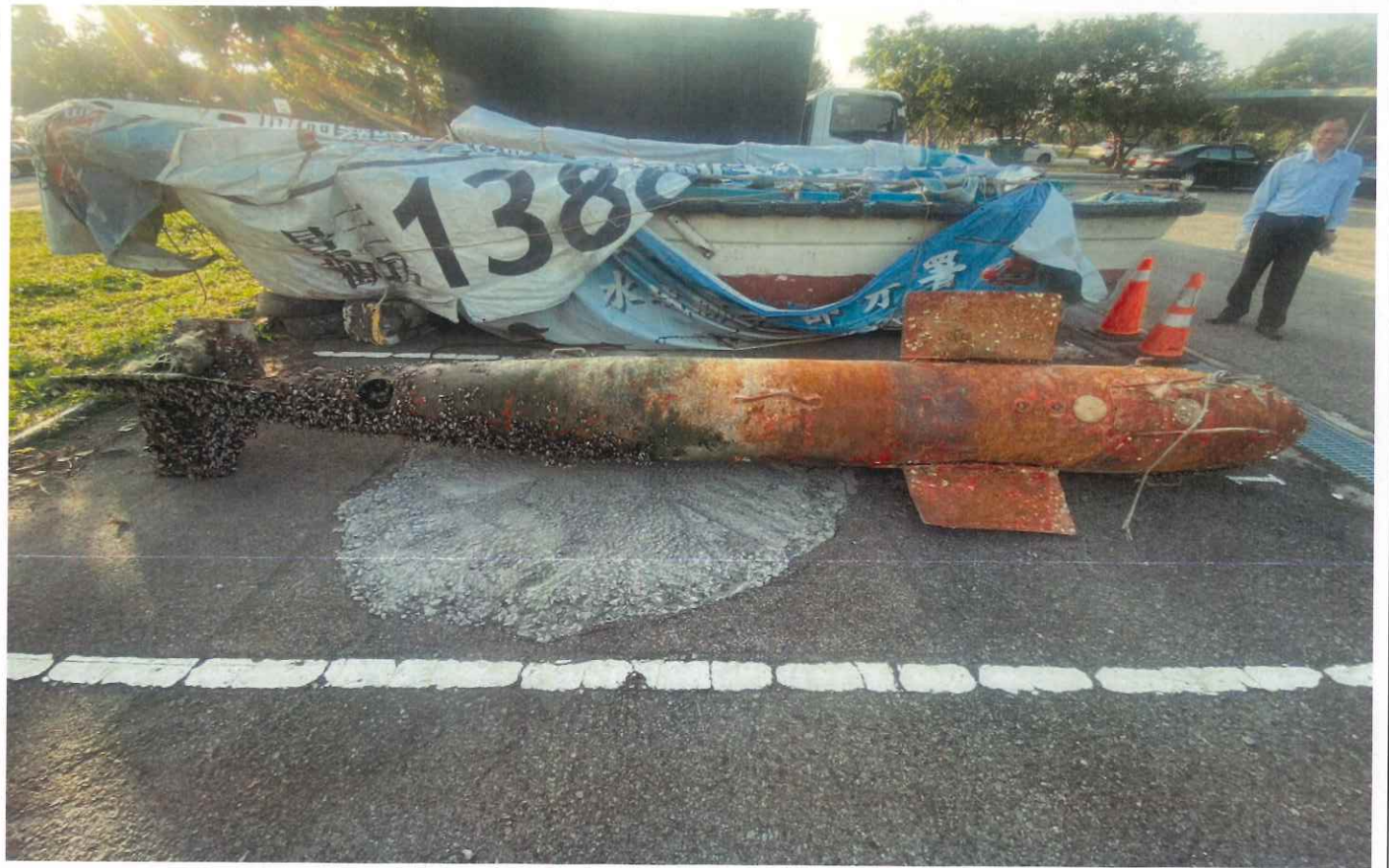
說明：儀器外觀(鋼質，長：476 公分、寬：56 公分、前翼：116 公分尾翼：60 公分)
