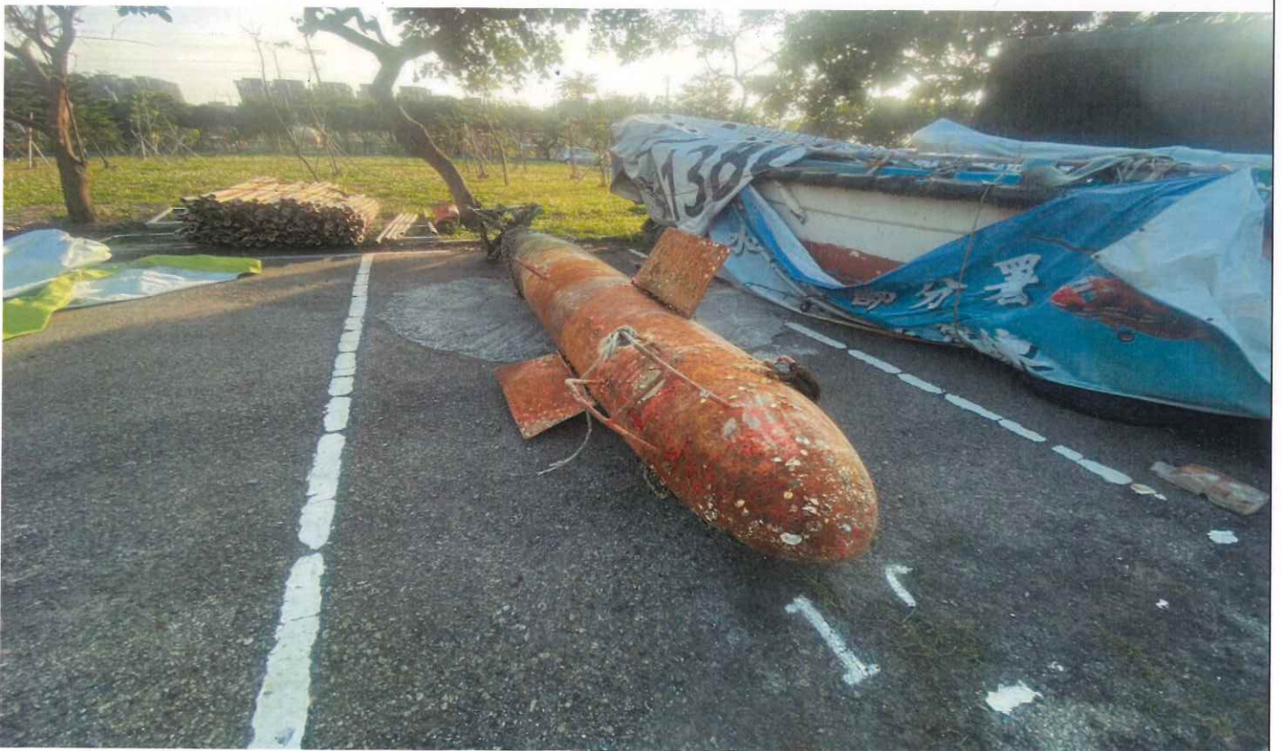
說明：儀器外觀(鋼質，長：476 公分、寬：56 公分、前翼：116 公分尾翼：60 公分)
