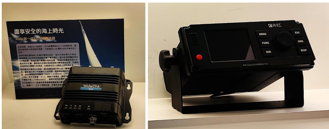
圖5-4：圖左為 AIS/B 型主機、右為 A 型主機其面板左半邊為 LCD 顯示，右為旋轉式按鈕可供使用者操作各項功能 (出處: 呂佳龍教官提供)
