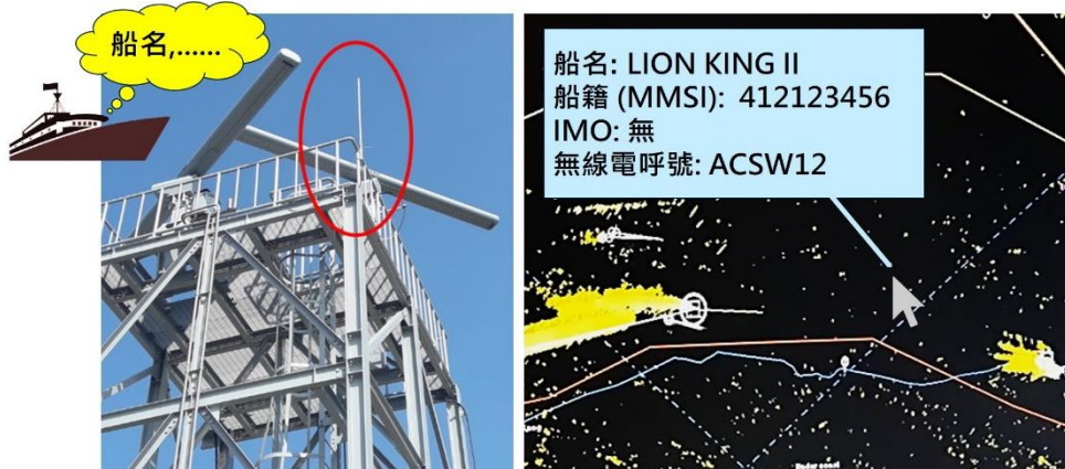
圖 1-2：船舶 AIS 資訊與 VTS 雷達之融合畫面
