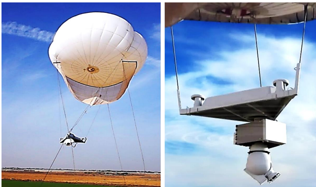
圖4-4：攜帶 EO/IR 於空中執行偵蒐任務的繫留式氣球 (出處：RT System)
