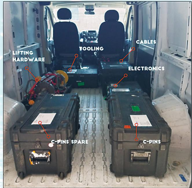
▲圖八 載於車上的全套C-PINS航行定位器組合包 (資料來源: LinkedIn.com, 2021年)
