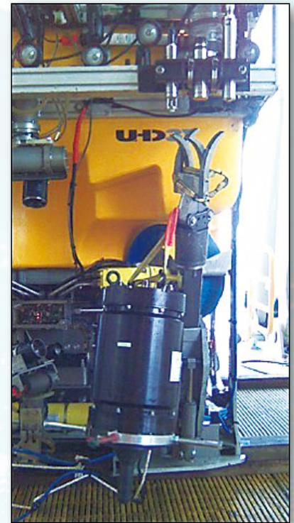
▲圖四 自主性水下載具上C-PINS航行定位器的裝設情形
