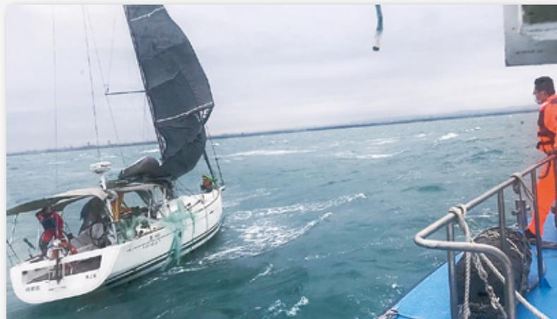
▲新竹海巡隊PP-3562艇巡邏時發現「飛樂比」帆船航跡異常，經廣播通聯後，確認該船因絞網造成機械故障失去動力
