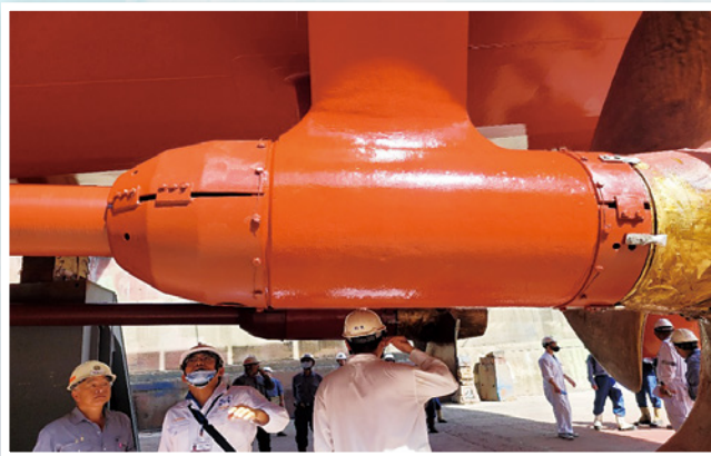
▲圖八 塢底I架及保護蓋圖（2024年，資料來源：作者自攝）
