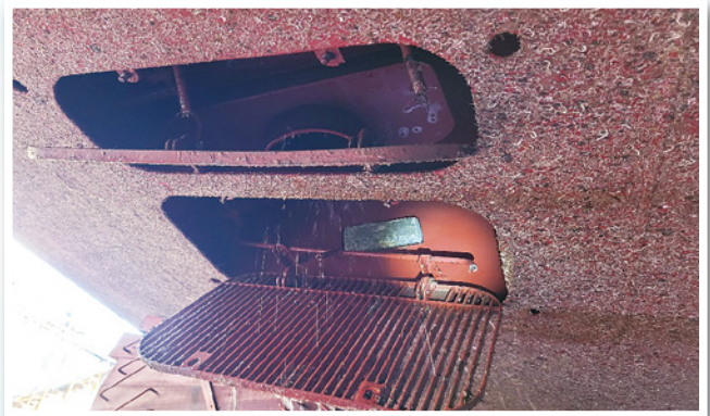
▲圖四 塢底海底門檢查狀況（2024年，資料來源：作者自攝）
