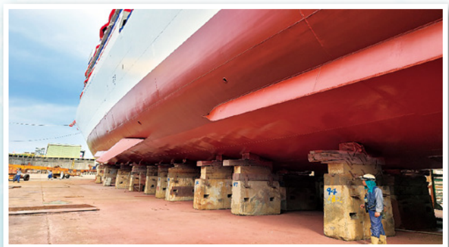
▲圖六 塢底船體水線下塗裝圖（2024年，資料來源：作者自攝）
