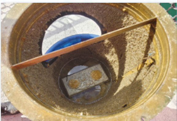
▲圖六 海底門閥後海水濾網狀況 （資料來源：作者自攝，2024年）
